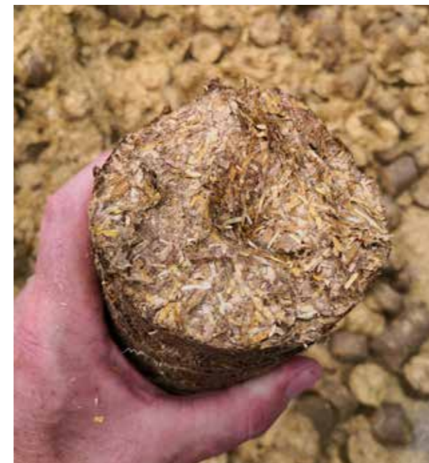
Billedet viser forarbejdet hvedehalm, der er komprimeret til en brikette med høj densitet. Dette betyder primært, at halmen nu kan anvendes direkte i bioanlægget uden yderligere behandling. Briketternes kompaktthed svarer til 3-4 gange af en big balle. Det betyder at lastbiltransporten til havnen reduceres tilsvarende 3-4 gange.
